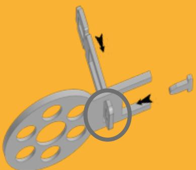
Вставьте кронштейн в прямоугольное отверстие платформы держателя и закрепите его шплинтом
